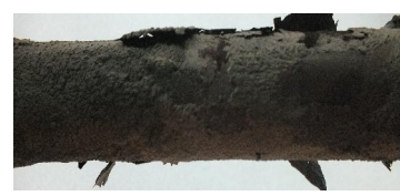
รูปที่ 6 ลักษณะทางกายภาพของอนุภาคที่เกาะบนท่อไอน้ำร้อนยวดยิ่ง(ต่อ)
