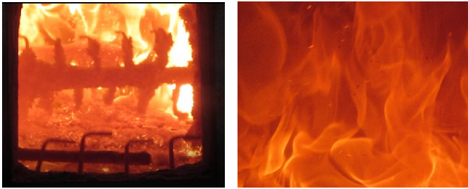
(ข) 53.6 wt% ถ่านหิน (ค) การปลิวของอนุภาคถ่านหิน รูปที่ 4 ลักษณะทางกายภาพของการเผาไหม้
