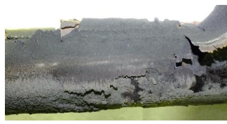
รูปที่ 6 ลักษณะทางกายภาพของอนุภาคที่เกาะบนท่อไอน้ำร้อนยวดยิ่ง(ต่อ)
