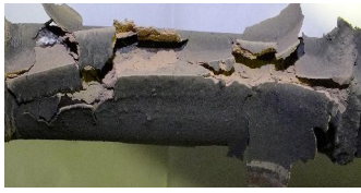
รูปที่ 6 ลักษณะทางกายภาพของอนุภาคที่เกาะบนท่อไอน้ำร้อนยวดยิ่ง(ต่อ)
