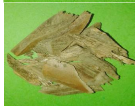
รูปที่ 2 ลักษณะทั่วไปของเปลือกทุเรียน (รูปบน) ทางตาล (รูปกลาง) และทางปาล์ม (รูปล่าง) ที่ผ่านกระบวนการทอริแฟกซ์ 300 °C ที่เวลาต่างกัน
