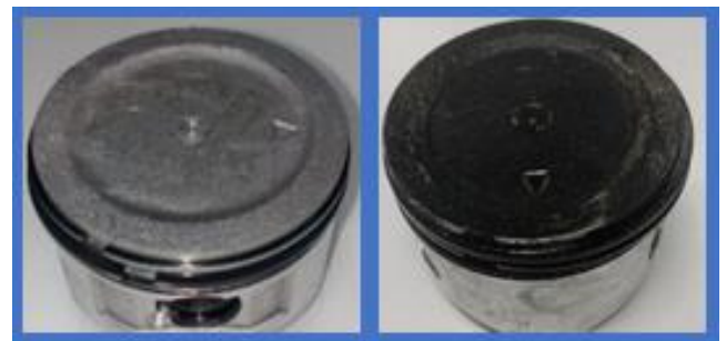
รูปที่ 8 ลูกสูบที่ผ่านการใช้ก๊าซชีววมวลเป็นเชื้อเพลิง
