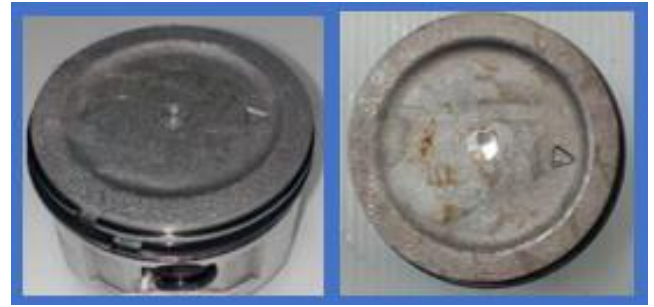
รูปที่ 6 ลูกสูบที่ผ่านการใช้ก๊าซชีวภาพเป็นเชื้อเพลิง
