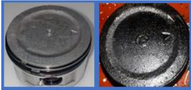
รูปที่ 10 ลูกสูบลูกผ่านการใช้ก๊าซชีวภาพร่วมกับก๊าซชีววมวลเป็นเชื้อเพลิง
