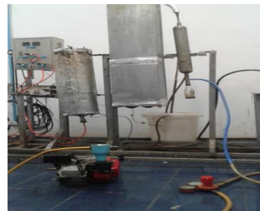
รูปที่ 9 การติดตั้งอุปกรณ์ก๊าซชีววมวลเข้ากับเครื่องยนต์ เพื่อทดลองใช้ก๊าซชีววมวลเป็นเชื้อเพลิง
