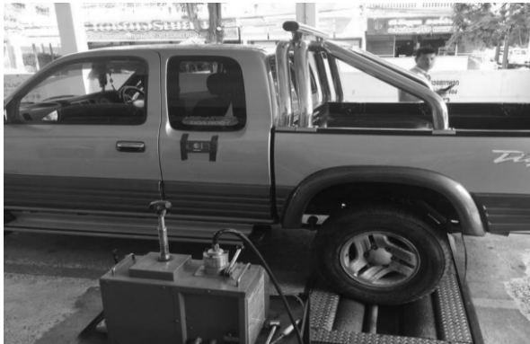
รูปที่ 1 เครื่องทดสอบเบรกที่สถานตรวจสภาพรถเอกชน
