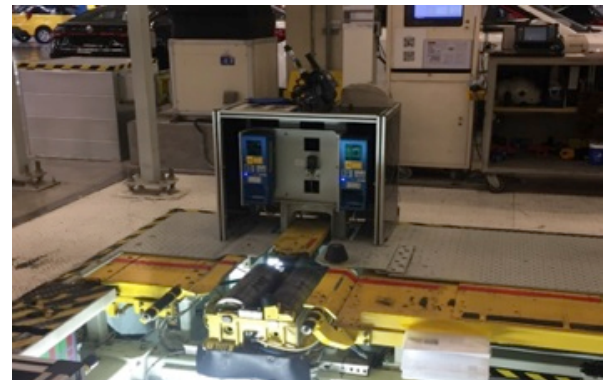
รูปที่ 4 เครื่องตรวจจับมุมล้อแคมเบอร์ที่สถานี WAHA
