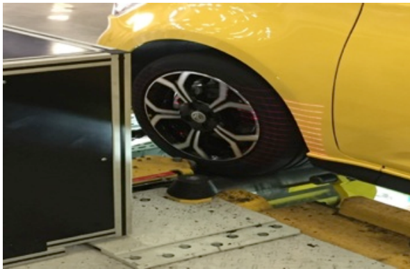
รูปที่ 5 เครื่องตรวจจับขณะกำลังตรวจจับมุมแคมเบอร์
