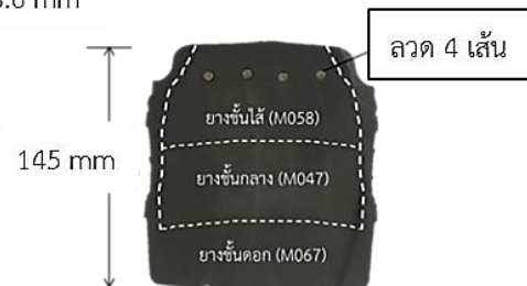
รูปที่ 3 ยางล้อต้นตัวอย่างขนาด 6.00-9 นิ้ว
