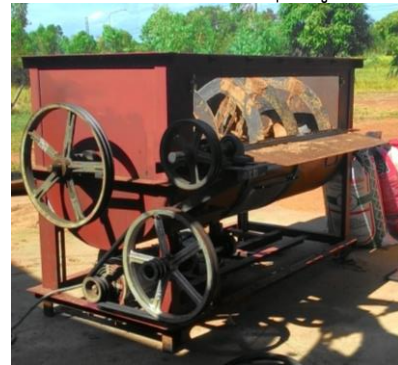
รูปที่ 1 เครื่องผสมเชื้อเห็ดแบบบริบบอนถ้งนอนที่ใช้ ระบบสายพานและมู่เเล่
