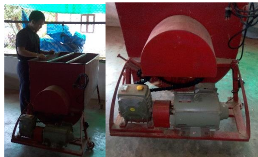
รูปที่ 2 เครื่องผสมเชื้อเห็ดแบบบริบบอนถ้งนอนที่ใช้ เกียร์ทดแบบเกิลียวตัวหนอน
