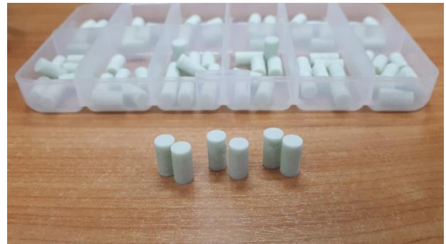
รูปที่ 2 ชิ้นทดสอบซีเมนต์กระดูกที่พร้อมสำหรับทดสอบการรับแรงอัด
