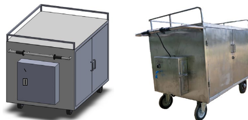
(ก) แบบรถเข็นผ้า (ข) รถเข็นผ้าที่สร้างขึ้น รูปภาพที่ 1 รถเข็นผ้าสะอาดของผู้ป่วยที่สร้างขึ้น
