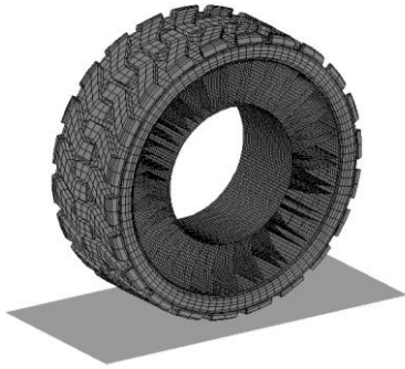
รูปที่ 10 แบบจำลองไฟไนต์เอลิเมนต์การสูญเสียฮีสเตอร์ซิสของยางล้อไร้ลม
