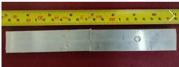
รูปที่ 6 ผลการทดสอบการเชื่อมแบบขั้วตีเชิงเส้น
