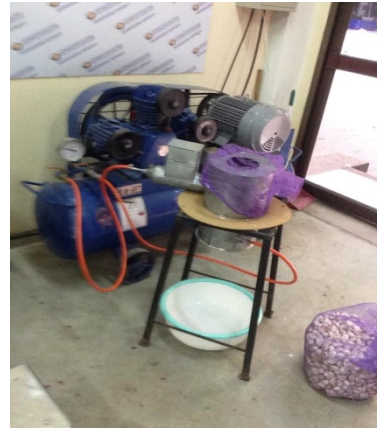
รูปที่ 1 ภาพเครื่องปอกเปลือกกลีบกระเทียมจีนด้วยการไหลของอากาศแบบปั่นป่วน
