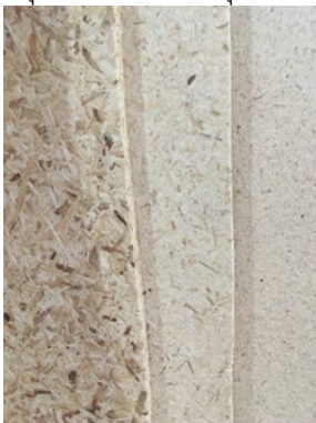
ภาพที่ 3 การเปรียบเทียบแผ่นวัสดุอัดขานอ้อยด้วยชิ้นวัสดุต่างขนาด
