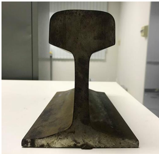
รูปที่ 7 รางรถไฟทดสอบชนิด BS100A
