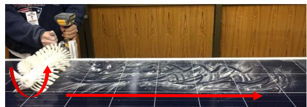
รูปที่ 7 แปรงแบบต่อกัน 2 โมดูล หมุนทางเดียวกับการเคลื่อนที่
