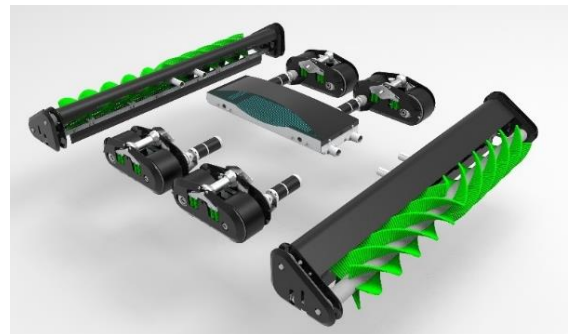
รูปที่ 3 ชิ้นส่วนต่างๆ ของหุ่นยนต์ หลังแยกออกเป็นแต่ละโมดูล
