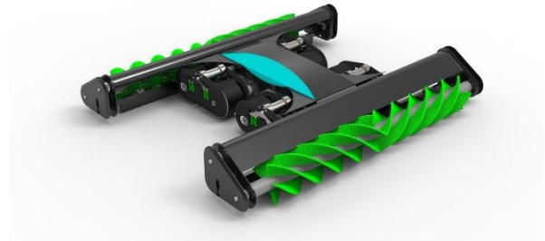
รูปที่ 2 หุ่นยนต์ทำความสะอาดแผงเซลล์ตาม คุณลักษณะที่สำรวจ
