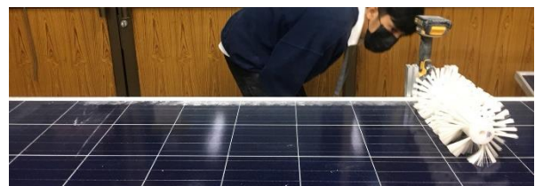
รูปที่ 8 ผลการทดสอบแปรงแบบต่อกัน 2 โมดูล หมุนทางเดียวกับการเคลื่อนที่
