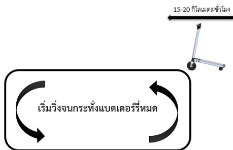
รูปที่ 4 แสดงการทดสอบระยะเวลาการใช้งานของ แบตเตอรี่
