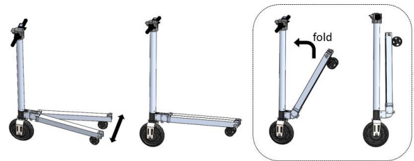
รูปที่ 6 แสดงขั้นตอนการพับเก็บของชุดเคลื่อนที่ขนาด เล็กแบบพกพาสำหรับผู้พิการและงานลาก
