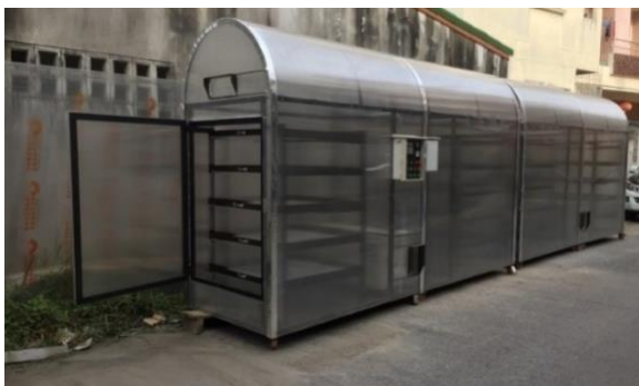
รูปที่ 2 ลักษณะและขนาดของโครงสร้างเครื่องอบพริก
