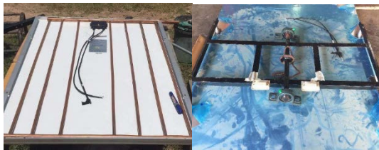
รูปที่ 2 ชุดท่อไหลเวียนน้ำและการปิดฉนวนสำหรับพื้นที่บรรจุวัสดุเปลี่ยนเฟส
