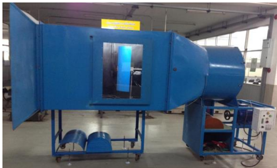
รูปที่ 2 ไดอะแกรมอุโมงค์ลมสำหรับการทดสอบ
