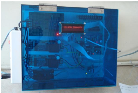
รูปที่ 9 ชุดอุปกรณ์วงจรทดสอบของเครื่องวัดพลังงาน
