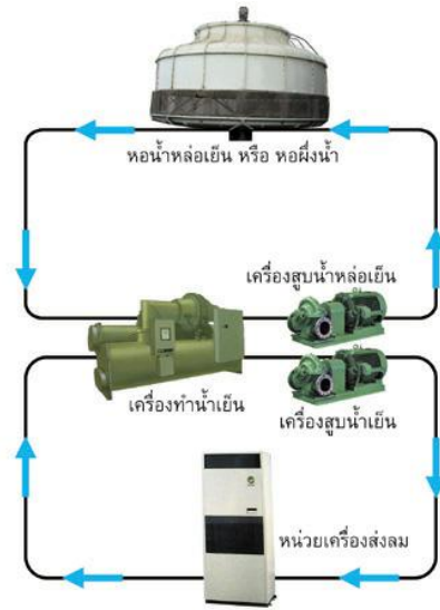
รูปที่ 1 ระบบปรับอากาศประเภท WATER COOLED WATER CHILLER
