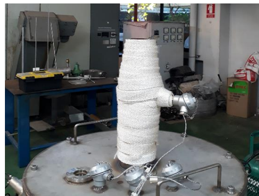
รูปที่ 3.3 ตำแหน่งการวัดอุณหภูมิของการทดสอบใช้งานจริงกับห้องเผาไหม้เครื่องกำเนิดไอน้ำแบบท่อขด
