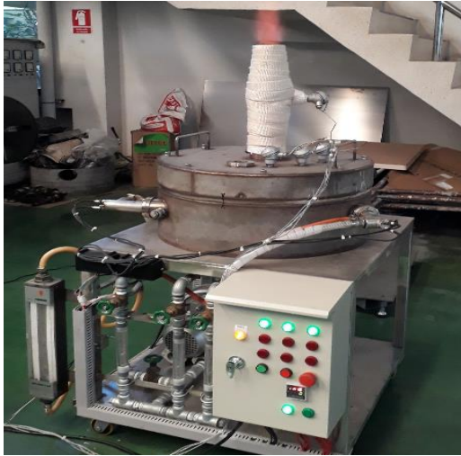
รูปที่ 3.4 การทดสอบใช้งานจริงกับห้องเผาไหม้แบบ 3 หัวเผา
