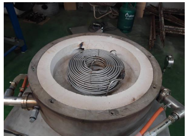
รูปที่ 3.2 ส่วนประกอบของท่อขดภายในห้องเผาไหม้ของเครื่องกำเนิดไอน้ำแบบท่อขด (STSG)
