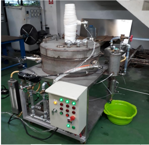
รูปที่ 3.3 การทดสอบสมรรถนะของเครื่องกำเนิดไอน้ำแบบท่อซัด (STSG)
