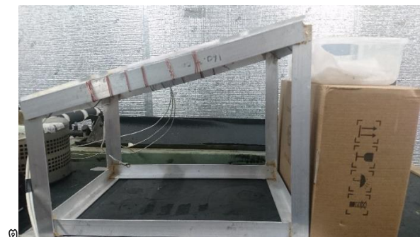
(ค) แผงจำลองโดยติดผ้าฝ้ายดูดซับน้ำด้านหลังแผงจำลองเซลล์แสงอาทิตย์
