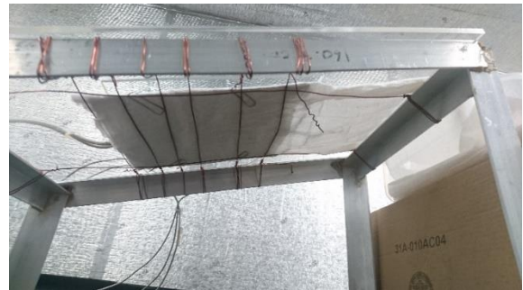
(ข) แผงจำลองโดยมีผ้าฝ้ายแห้งติดหลังแผงจำลองเซลล์แสงอาทิตย์
