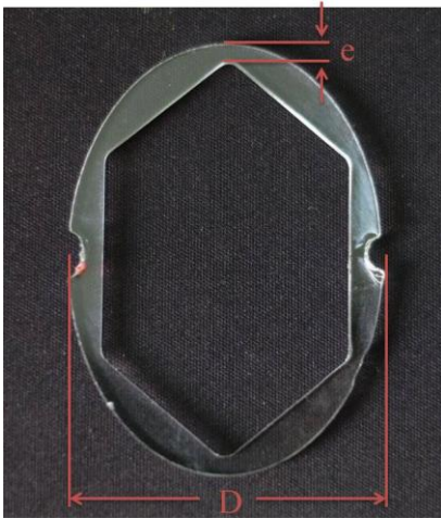
รูปที่ 2 ลักษณะการติดตั้งวงแหวนหกเหลี่ยมเอียงในท่อทดสอบ
