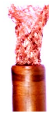
รูปที่ 3 วัสดุพูนชนิดตาข่ายภายในห้องความร้อน
