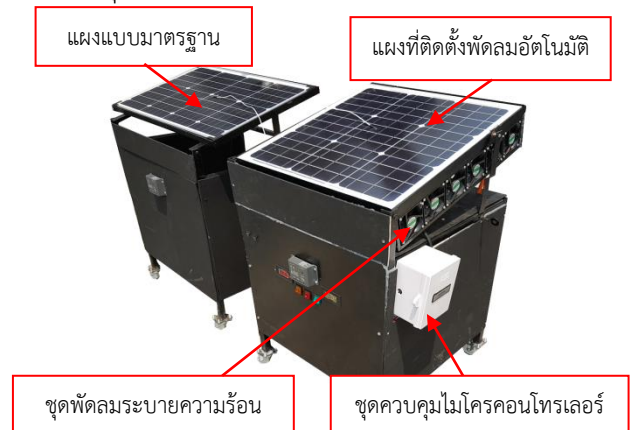
รูปที่ 4 แผงโซลาร์เซลล์ที่ใช้ในการทดลองแบบมาตรฐาน และแบบที่ติดตั้งพัดลมระบายความร้อน
