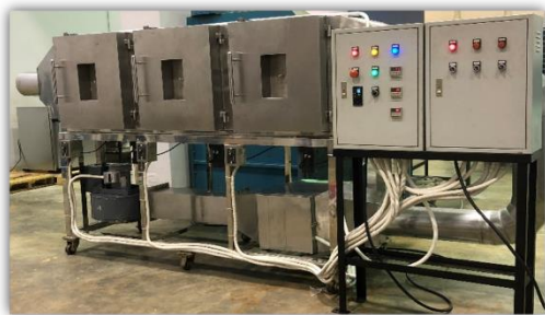
รูปที่ 1 เครื่องอบแห้งสับประรดพันธุ์ภูแลด้วยไมโครเวฟร่วมกับลมร้อน
