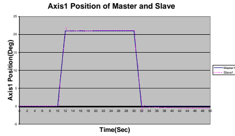
รูปที่ 12 การเคลื่อนที่ข้อต่อที่ 1 ซึ่งมีตัวหน่วงเวลาโดยใช้ตัวแปรคลื่น
