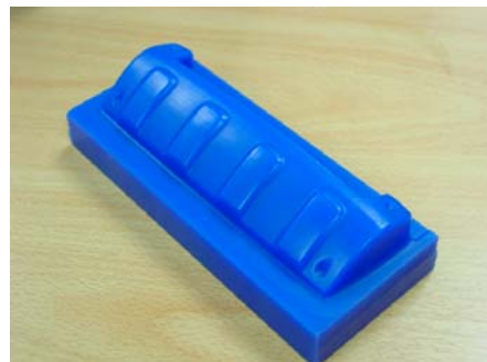
รูปที่ 7 กันชนรถยนต์และต้นแบบที่ลดขนาดลงเหลือ 17.5%
