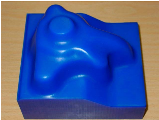
รูปที่ 8 แม่พิมพ์ดุมล้อ EDM และต้นแบบที่ลดขนาดลงเหลือ 60%
