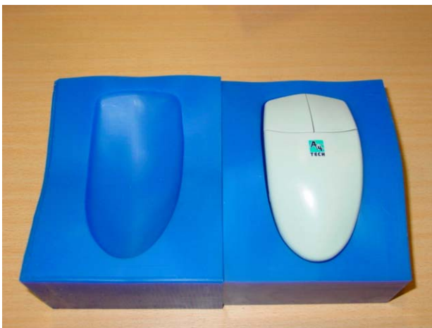
รูปที่ 4 แม่สีคอมพิวเตอร์และแม่พิมพ์ประกบที่ขยายใหญ่ขึ้น 3 %
