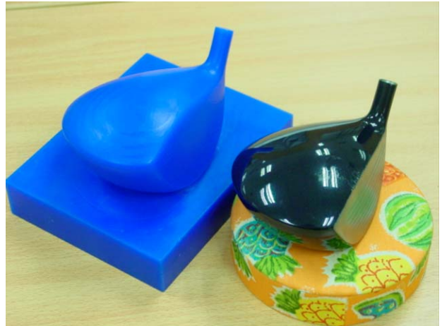
รูปที่ 6 หัวไม้กอล์ฟพร้อมต้นแบบที่ขยายขนาดใหญ่ขึ้น 5%
