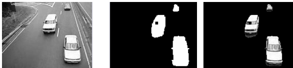
รูปที่ 4 การแยกพื้นหน้า, (ก) Original, (ข) Segment และ (ค) Foreground
