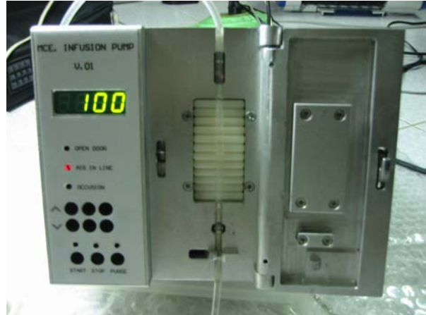
รูปที่ 5 ลักษณะการใส่สายน้ำเกลือกับเครื่องต้นแบบเครื่องให้น้ำเกลือสำหรับผู้ป่วย
