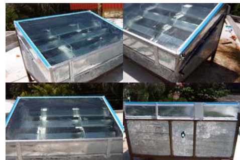
รูปที่ 1 รูปแบบของเครื่องกลั่นน้ำพลังงานแสงอาทิตย์ที่ใช้ศึกษาทดลอง
