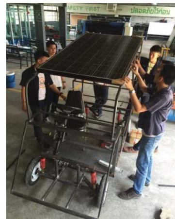
รูปที่ 5 การติดตั้งแผงเซลล์แสงอาทิตย์เข้ากับโครงรถ
