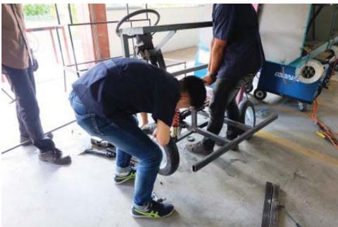
รูปที่ 3 การประกอบชุดบังคับเลี้ยวและติดตั้งระบบกันสะเทือน
