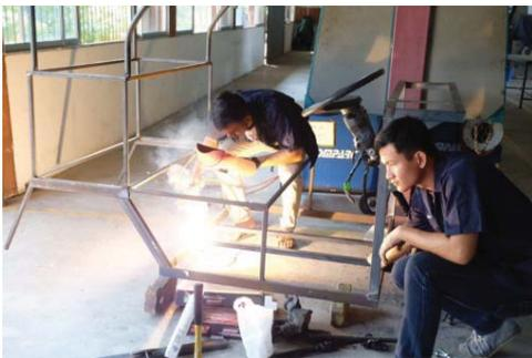
รูปที่ 2 การเชื่อมชิ้นส่วนเหล็กที่ตัดไว้ตามแบบ
