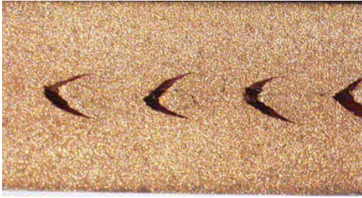
รูปที่ 12 ภาพขยาย 7 เท่าของเส้นลวดทองแดงที่ผ่าออกเป็นสองส่วนตามแนวแกนกลางของเส้นลวดทองแดงที่ผ่านการดึงขึ้นรูปมาแล้ว 11 เที้ยว (ครั้ง) มุมครึ่งตาย 15 องศา
