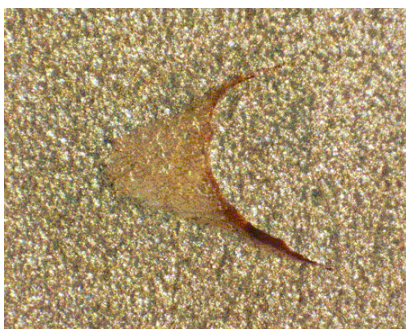
รูปที่ 14 ภาพขยาย 20 เท่าของเส้นลวดทองแดงที่ผ่าออกเป็นสองส่วนตามแนวแกนกลางของเส้นลวดทองแดงที่ผ่านการดึงขึ้นรูปมาแล้ว 11 เที้ยว (ครั้ง) มุมครึ่งตาย 15 องศา
