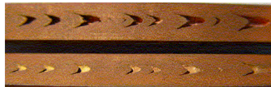
รูปที่ 10 แสดงภาพเส้นลวดทองแดงที่ผ่าออกเป็นสองส่วนตามแนวแกนกลางของเส้นลวดทองแดงที่ผ่านการดึงขึ้นรูปมาแล้ว 8 เที้ยว (ครึ่ง) มุมครึ่งตาย 22.5 องศา
