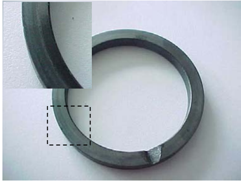
ภาพที่ 6 ชิ้นงานหน้าสัมผัสตัวอย่าง B ภาพเล็กขยายให้เห็นรอยสึกที่บริเวณล่อมด้วยเส้นประ
