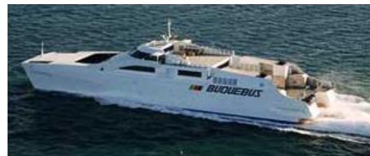
รูปที่ 2 เรือโดยสาร Ferry ใช้ Waterjet ขับเคลื่อน
