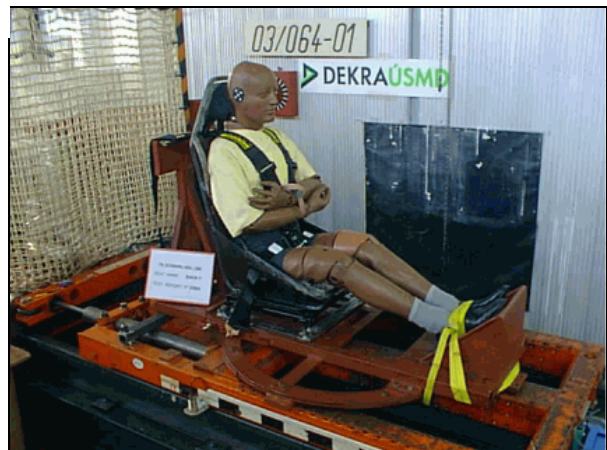
รูปที่ 3 ลักษณะการยึดหุ่นทดสอบและโครงเบาะ
