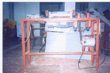
ภาพที่ 4 ชุดทดสอบเมล็ดถั่วลิสงด้วยอากาศร้อนที่ใช้ในการศึกษา
