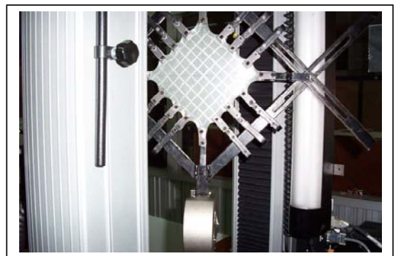
รูปที่ 3 ลักษณะการเปลี่ยนรูปของชิ้นทดสอบภายใต้การรับโหลดแบบการดึงสองแกนเท่ากัน
