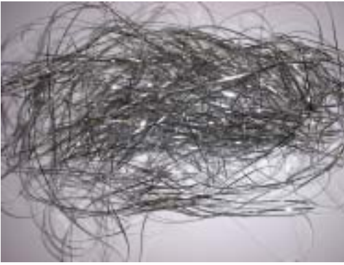
รูปที่ 2 รูปถ่ายแสดงตัวอย่างชิ้นงาน SMA ริปบิ้น ที่ผลิตด้วยความเร็วหมุนโรลเลอร์ 4000rpm
