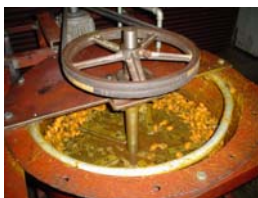
รูปที่ 6 การแยกเปลือกปาล์มออกจากเมล็ดภายในถัง
