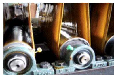
รูปที่ 16 ลักษณะของสายพานขณะบีบเนื้อปาล์ม
