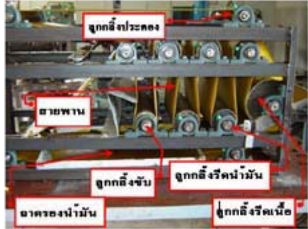
รูปที่ 9 เครื่องบีบน้ำมันปาล์มแบบสายพานกรองอัตโนมัติ
