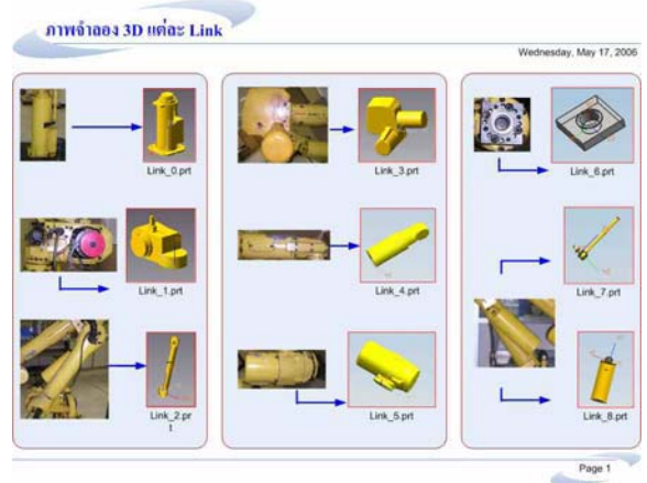
รูปที่ 3 เปรียบเทียบข้อมูลแต่ละชิ้นส่วนของหุ่นยนต์ จริงกับ Link ที่ได้จำลองขึ้น
