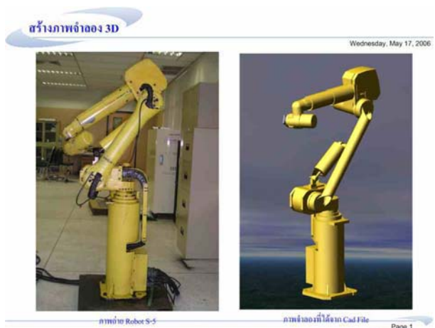
รูปที่ 1 Fanuc Robot S-5 ภาพจริง และ ภาพ จำลอง 3D
