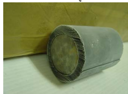
รูปที่ 2 ชิ้นงานยางที่ใช้ในกระบวนการกลึง
