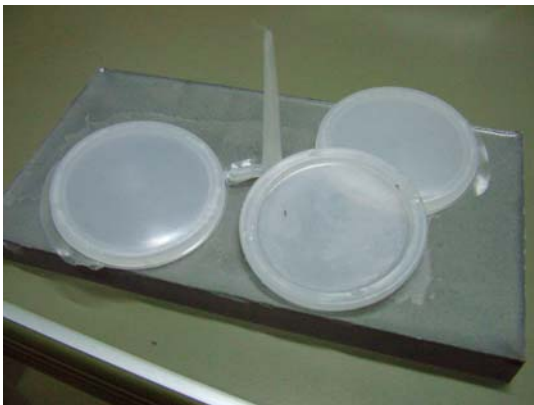
รูปที่ 10 ตัวอย่างชิ้นงานที่ได้จากการฉีดชิ้นงานพลาสติกประเภท PP
