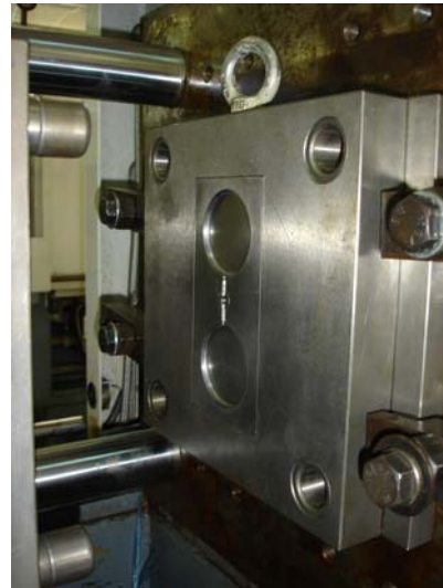
รูปที่ 4 การติดตั้งแม่พิมพ์ที่สร้างขึ้นกับเครื่องฉีดพลาสติกขนาด 40 ton
