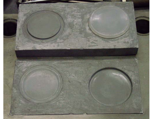
รูปที่ 7 ผิวของแผ่นคอร์และคาร์วีตี้เมื่อนำแม่พิมพ์โมเดลออกแล้ว
