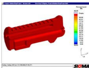
รูปที่ 17 แสดงเปอร์เซ็นต์การสุกของเนื้อยางภายในชิ้นงาน ที่เวลา 60 วินาที
