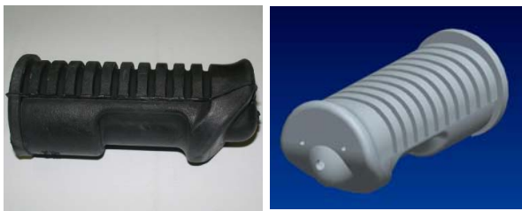
รูปที่ 1 ยางที่วางเท้าที่ใช้ในการเหยียบเบรกในรถจักรยานยนต์
