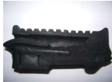
รูปที่ 19 ภายในของชิ้นงานที่เนื้อยางไม่สุกบริเวณที่ติดกับตัว Insert
