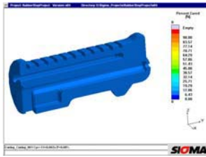
รูปที่ 16 แสดงเปอร์เซ็นต์การสุกของเนื้อยางภายในชิ้นงานที่เวลาเริ่มต้น
