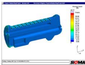
รูปที่ 16 แสดงเปอร์เซ็นต์การสุกของเนื้อยางภายในชิ้นงานที่เวลาเริ่มต้น
