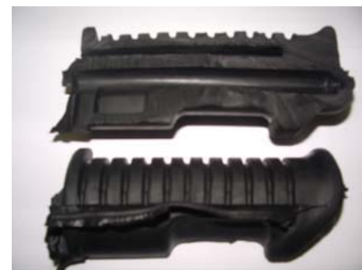
รูปที่ 20 ภายในของชิ้นงานที่เนื้อยางสุกทั่วถึงกัน
