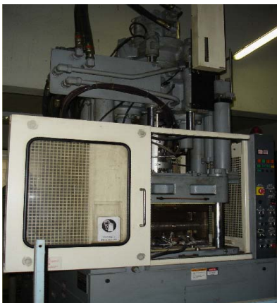
รูปที่ 4 เครื่องฉีดยางระบบขับเคลื่อนด้วยไฮดรอลิก แนวตั้งขนาด 100 ตัน
