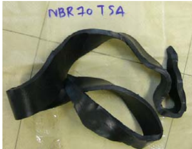
รูปที่ 3 ยางผสมสำหรับป้อนเข้าเครื่องฉีด ชนิด NBR ความแข็ง 70 ชอร์
