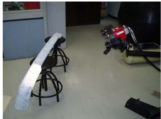
รูปที่ 15 แสดงการเก็บพิกัดกันชนรถยนต์โดยใช้เครื่องเก็บพิกัดสามมิติระบบอปติค
