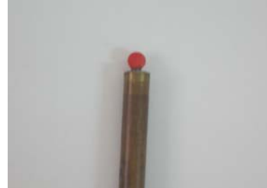
รูปที่ 1 แสดงการติดเทอร์มิสเตอร์ที่ปลายโพรบ
