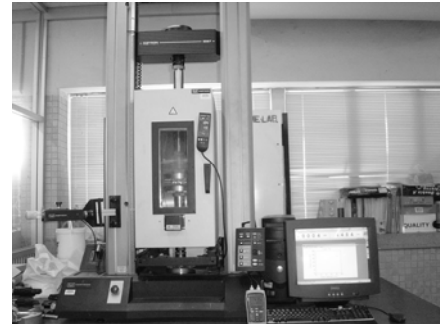
รูปที่ 6 เครื่องทดสอบการกดยี่ห้อ Instron 5567
