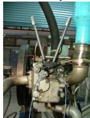
รูปที่ 15 แสดงฝาสูบของเครื่องยนต์วิจัยขณะติดตั้งอยู่บนแท่นทดสอบ
