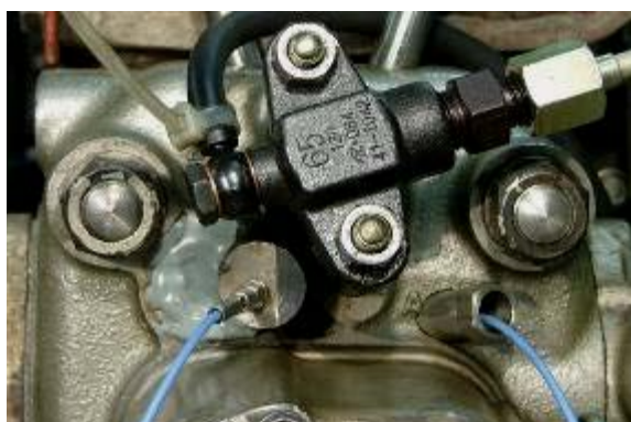
รูปที่ 14 แสดงฝาสูบที่ได้รับการดัดแปลงเพื่อติดตั้ง pressure transducer ที่ prechamber และ main chamber เรียบร้อยแล้ว
